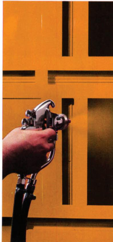
... die anschließende Lackierung festen Halt findet. Die Zusammensetzung des dabei verwendeten Speziallackes ist auf die in den chemischen Bädern entstandene Haftschrift abgestimmt.
