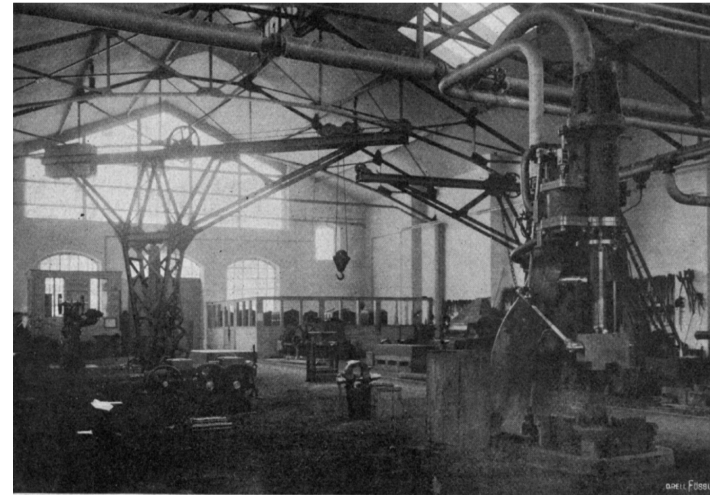
Phot. H. Nyffel. Die neuen Reparaturwerkstätten der S. B. B.: Interieur aus der Schmiede, moderner Dampfhammer (Bätz 750 kg, Schlagkraft mehrere tausend kg).
