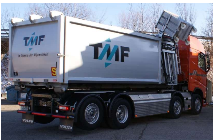
Mulde mit Seitenlift für das Beladen mit 800l-Containern.
